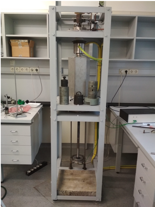
(a) Az általam felújított benyomódási kúszásmérő, mellyel a méréseket végeztem.
