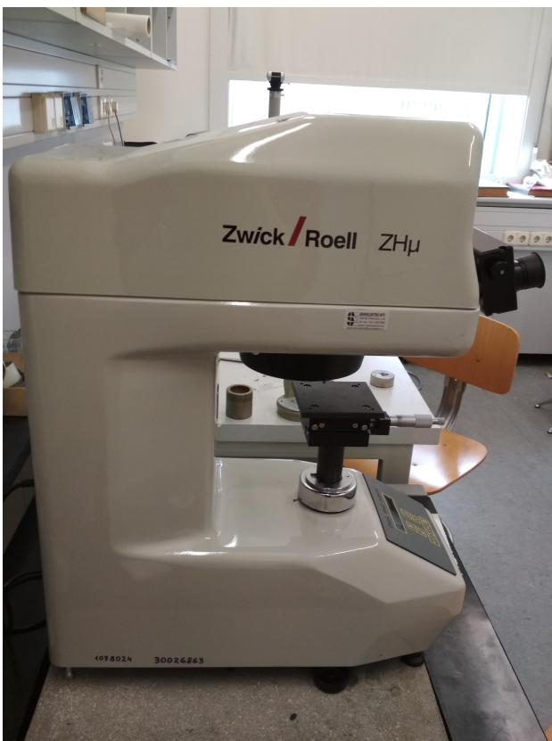
(c) A mikrokeménységméréshez használt ZwickRoell ZH \mu eszköz.
