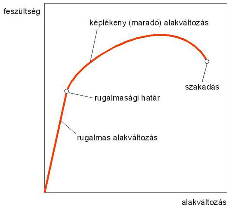
1. ábra: Szakítódiaagram vázlata (forrás: Wikipédia)
